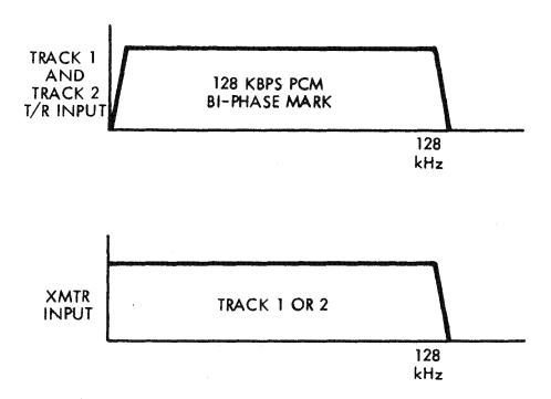
Fig. 3-1 Data Format: 1:1 Readout Mode (Wideband FM Mode)
